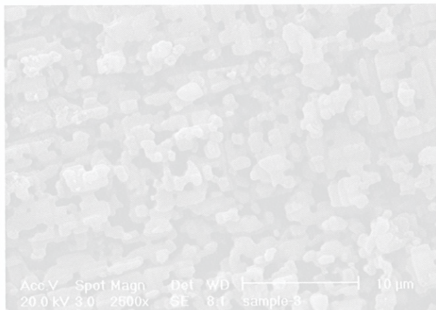
Bild 2: Elektronenmikroskopische Aufnahme der Oberfläche einer geätzten Hochvolt-Anodenfolie.
