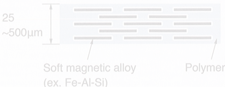
Bild 1: Das Abschirmmaterial Flex Suppressor von Kemet setzt sich aus einem Polymer und einem weichmagnetischen Abschirmmaterial zusammen.
