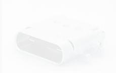
Zum Lieferprogramm von RS Components gehört die neueste USB-C-Buchse von TE Connectivity (TE). Die Buchse, die mehrere Verbindungsstandards unterstützt, ist konzipiert für Datenraten bis 10 GBit/s (USB 3.1) und eine Energieversorgung bis 100 W bei 20 V. Das TE-Produkt für die Leiterplattenmontage zeichnet sich insbesondere durch sein schlankes Profil aus. (cp)
